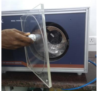
STEP – 3 : Remove the Acrylic door
